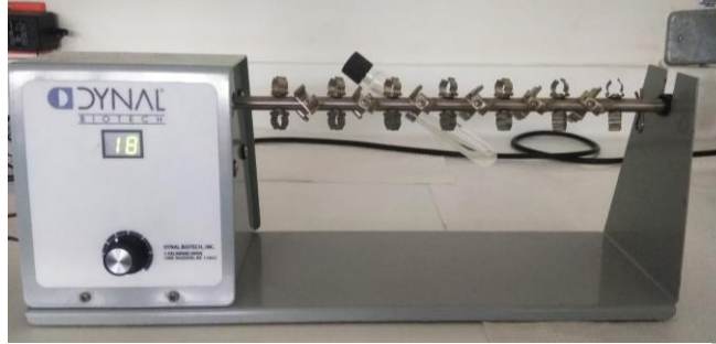
Figura 6. Separación inmunomagnética - Periodo de incubación de la muestra con las perlas de cobre recubiertas con anticuerpos Anti-Cryptosporidium y Anti-Giardia
